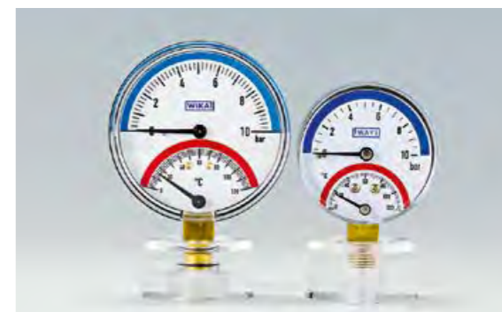
Auszeichnung: Bimetall-Thermomanometer (Druck- und Temperaturmessung). Links das Original von Wika Alexander Wiegand SE & Co. KG, Deutschland. Rechts die Fälschung. Vertrieb über ebay.de, Deutschland. Versand: ShunShun GmbH, Deutschland
