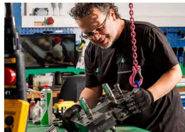
Die Spritzgießformen müssen regelmäßig gereinigt und gewartet werden. Zur Reinigung und Reparatur werden die Gussformen in ihre Einzelteile zerlegt.
