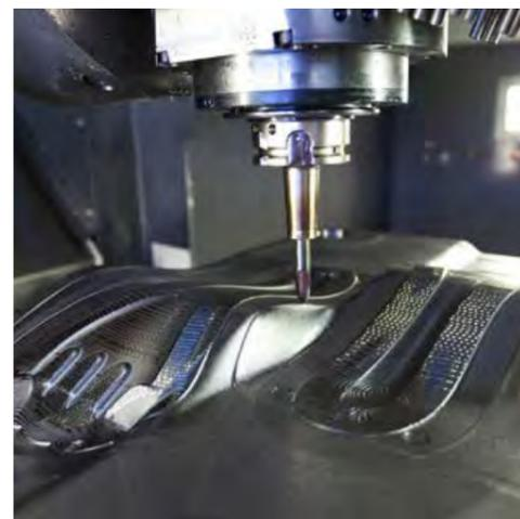
Koziol stellt die Formen für seine Produkte im hauseigenen Werkzeugbau selbst her. Hier der Blick in eine CNC-Fräsmaschine.
