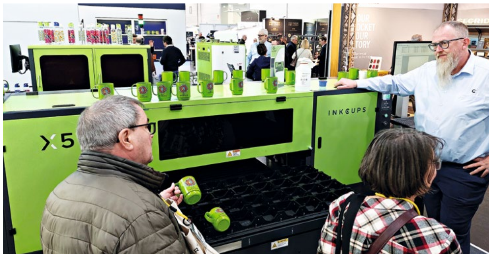
Der X5-T High Throw UV-Flachbettdrucker, der hochwertige, präzise Drucke auf konturierten, abgerundeten, leicht gekrümmten und unregelmäßig geformten Objekten ermöglicht.
