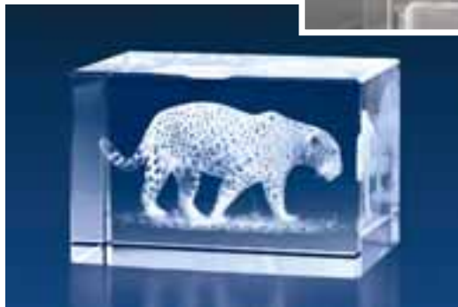
Von der Vorlage wird im PC ein 3D-Modell erstellt, eine sogenannte Punktwolke. Der Laserstrahl schmilzt die einzelnen Punkte im Glas, so dass eine dreidimensionale Gravur entsteht.
