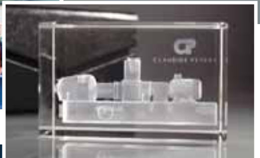
Von der Vorlage wird im PC ein 3D-Modell erstellt, eine sogenannte Punktwolke. Der Laserstrahl schmilzt die einzelnen Punkte im Glas, so dass eine dreidimensionale Gravur entsteht.
