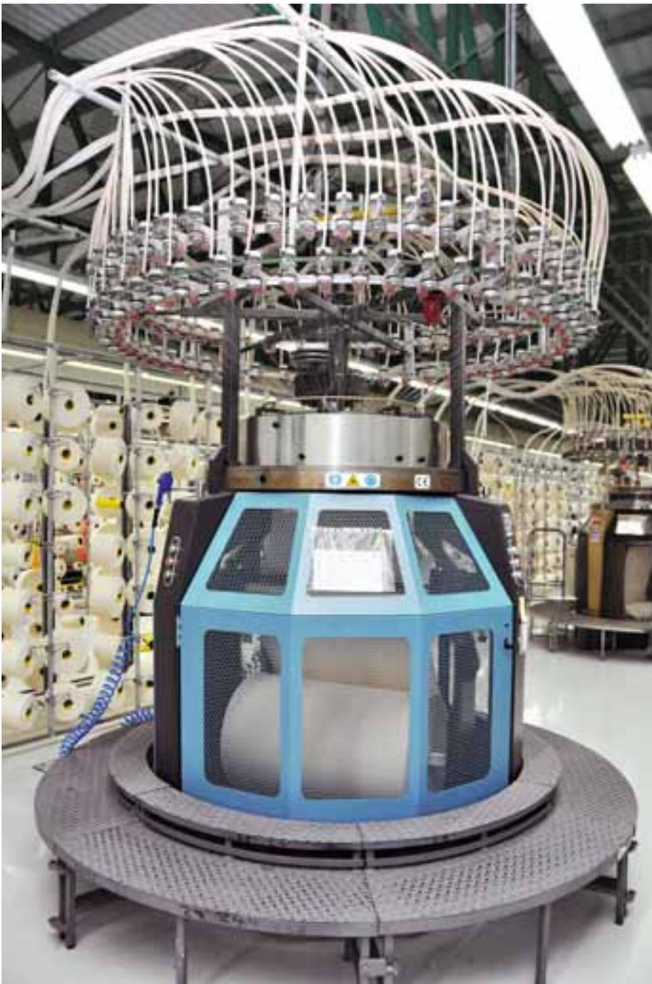
Eine der Hochgeschwindigkeits-Strickmaschinen.
