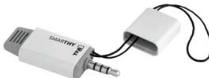
Smarchy, ein kleines Thermo-Hygrometer, das komfortabel über eine App auf dem Smartphone bedient wird.
