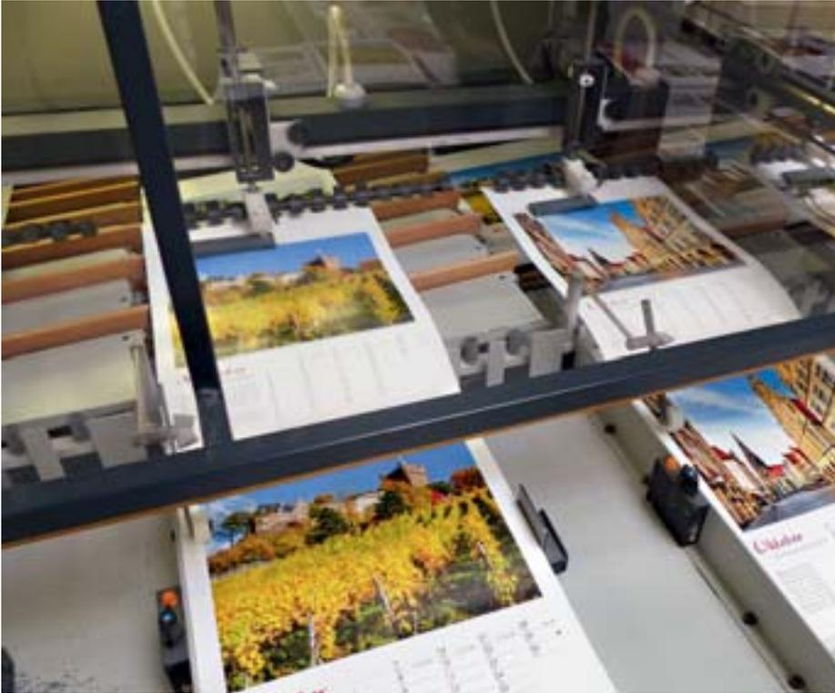
Die einzelnen Blätter des Bildkalenders werden maschinell zu einem Gesamtwerk zusammengeführt.
