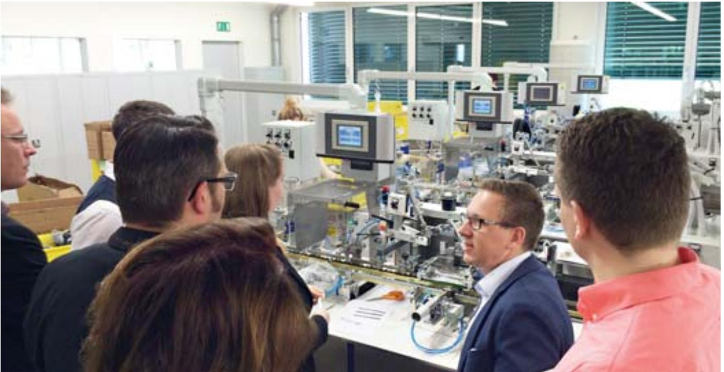
Eine Tampondruckmaschine für Mehrfarbdrucke auf Schreibgeräten.
