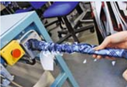
Die Einlage wird eingenäht und dann eingezo-gen. Dann wird die Krawatte gewendet.
