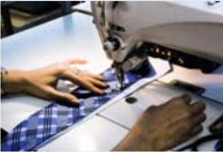
Nun werden die drei Komponenten der Krawatte zugeschnitten und zusammengenäht.
