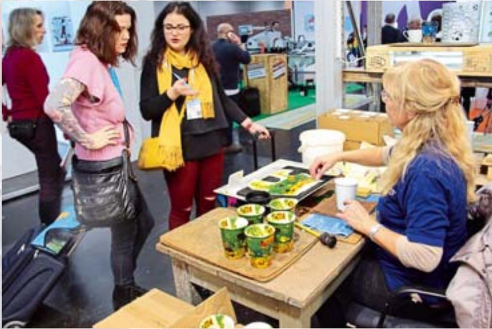
Keramische Schiebebilder werden einzeln von Papier auf den Becher übertragen und dann bei 800 °C gebrannt.
